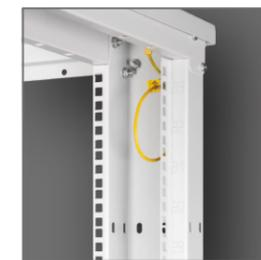
Опоры выполнены из профилированной 1,5 мм стали. Максимальная распределенная нагрузка — до 650 кг. Рамы упакованы отдельно от крыши и основания, что позволяет обеспечить надежную и компактную упаковку.
