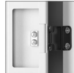
Каждая створка двери крепится на 3 внешние петли с углом открывания 180°. Двери могут быть установлены в любых конфигурациях: как спереди, так и сзади шкафа. Направление открывания также легко изменить в любой момент, перенавесив дверь.
