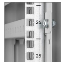
Направляющие выполнены из оцинкованной 1,5 мм стали. Профиль имеет S-образную форму и поддерживает штатную установку любых полок TLK. Глубина установки направляющих регулируется. В комплект входит клейкая лента для нанесения маркировки юнитов.
